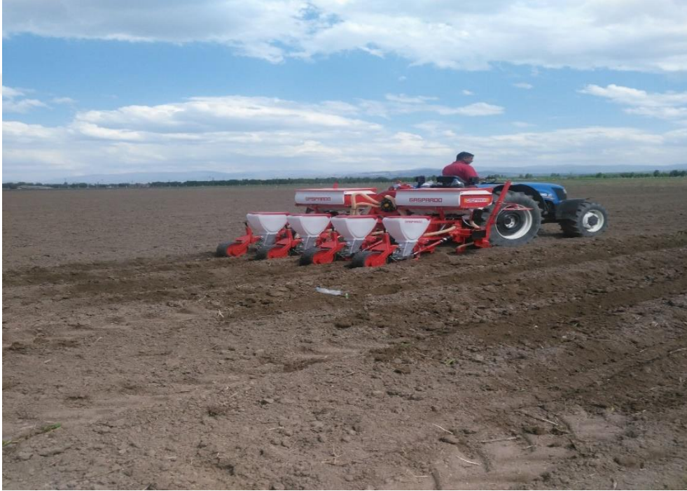
Şekil 3.1. Denemede kullanılan ayçiçeği ekim makinası
